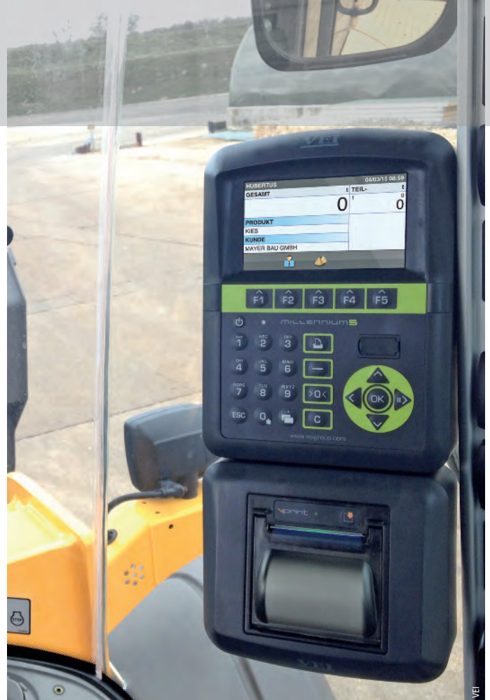
Das große Farbdisplay der Wägesysteme Millennium 5 und Helper X, ist auch bei direkter Sonneneinstrahlung noch gut ablesbar.
