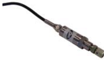
Sensores de carga , uno en cada suspensión
