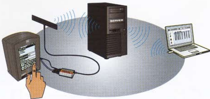
Trackweight通过互联网向VEI服务器发送数据
